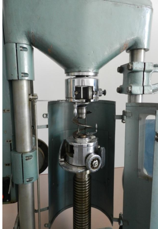
Рис. 2. Загальний вигляд машини на кручення КМ–50–1 з дослідними зразками секцій робочих органів
