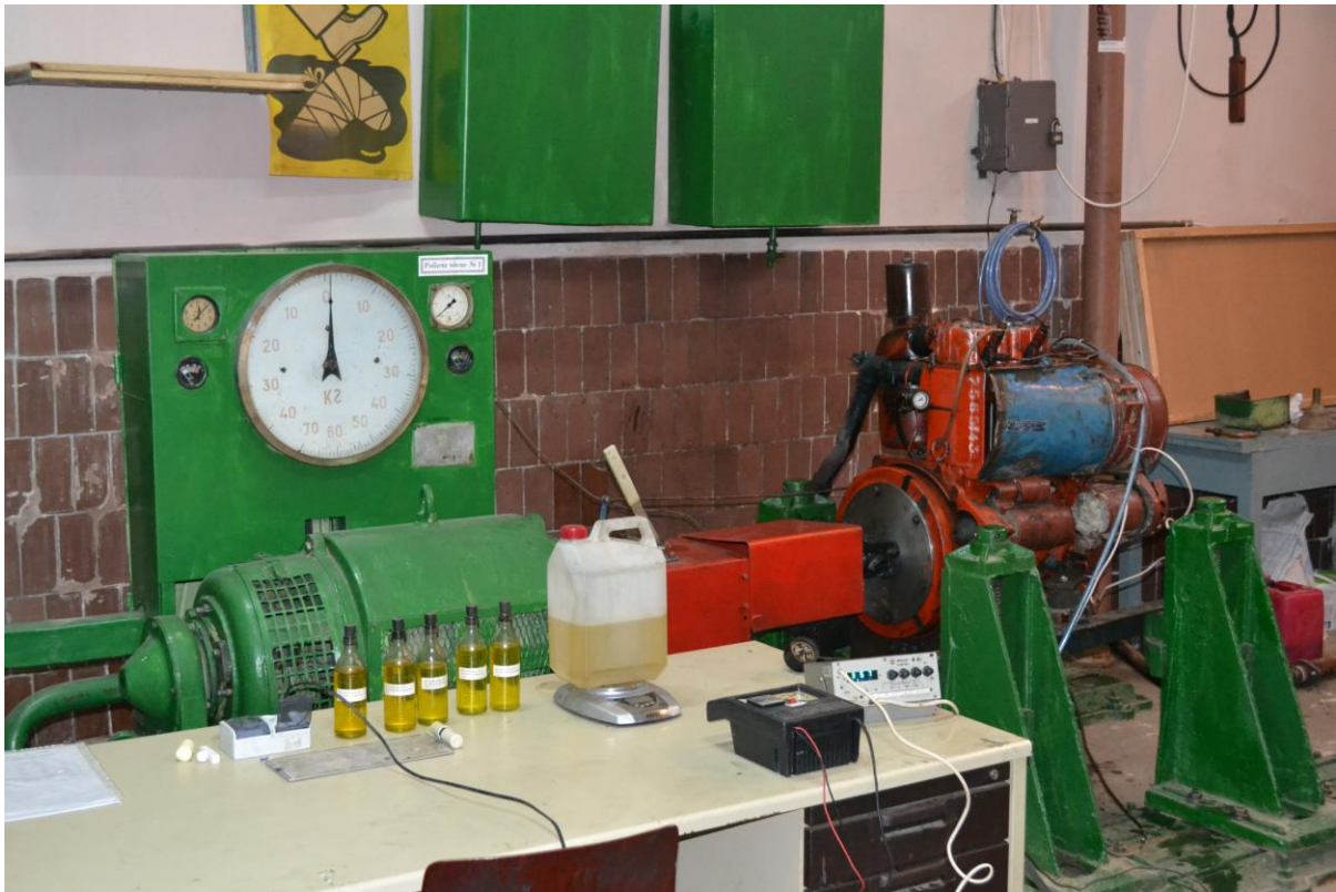
Рис. 1 Лабораторна установка для випробовування дизельного двигуна на альтернативних видах палива.
