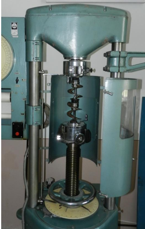
Рис. 2. Загальний вигляд машини на кручення КМ–50–1 з дослідними зразками секцій робочих органів
